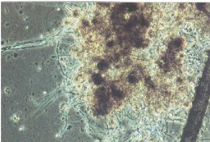
Kuva 3.3.2. 100-kertaisesti suurennettu mikroskooppikuva hakkeen pinnalta otetusta näytteestä.
