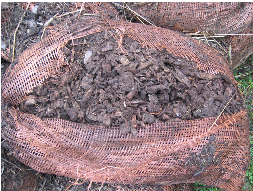
Kuva 3.3.1. Hakesuodattimessa käytettyä puuhaketta.
