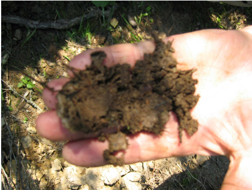
Kuva 3.4.1. Puuhakesuodattimen yläpuolelta poistettua lietettä.
